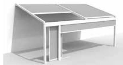
*Lagune équipée d'un Fixscreen intégré et d'une porte coulissante au moyen de Loggiascreen Canvas à l'avant (Front)*
