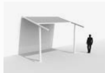
Avec dépassement de toiture (colonnes décalées)
